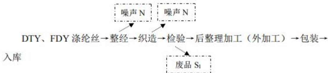
图 3-3 经编面料生产工艺和产污环节图
